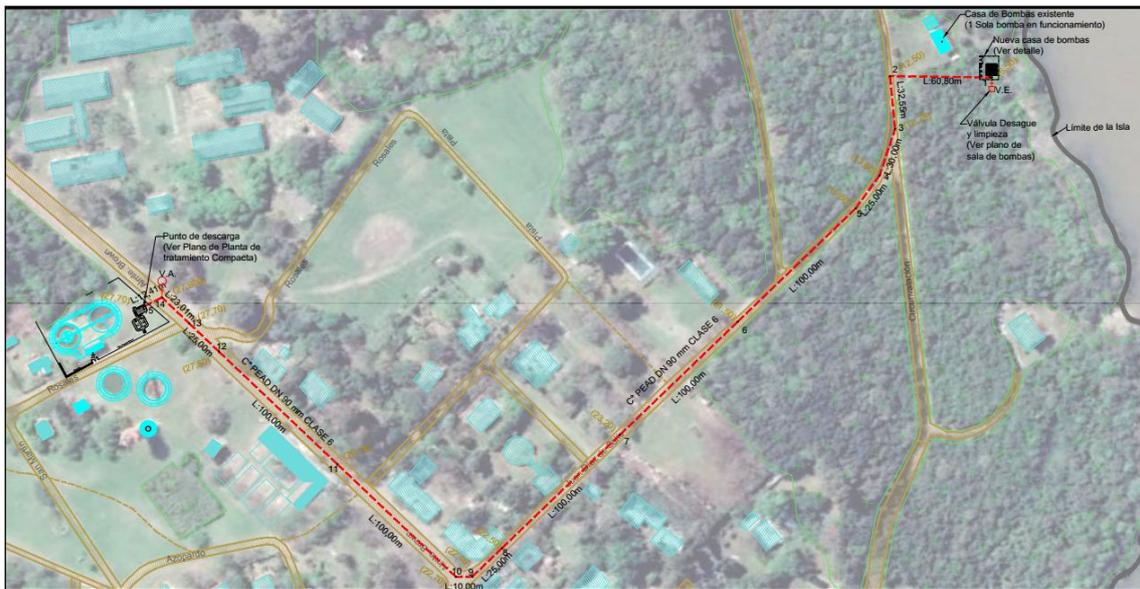
**Figura 6: Cañería de impulsión desde Estación elevadora a Planta potabilizadora.**
